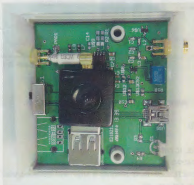
写真2 ケースにパネルと基板を一緒に差し込む
