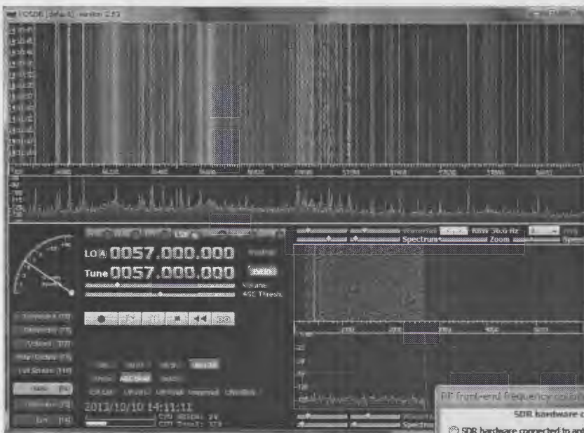
図5 HSDRで7MHzを受信した例(表示周波数は修正前なので、57MHzとなっている)
